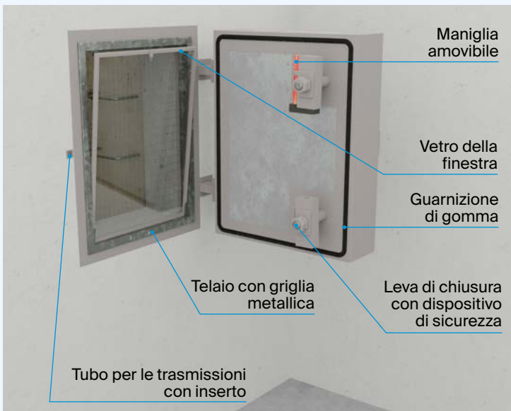
Fig. 6 L'uscita d'emergenza viene chiusa con un coperchio blindato. In quest'area si trova anche la presa d'aria del rifugio.
