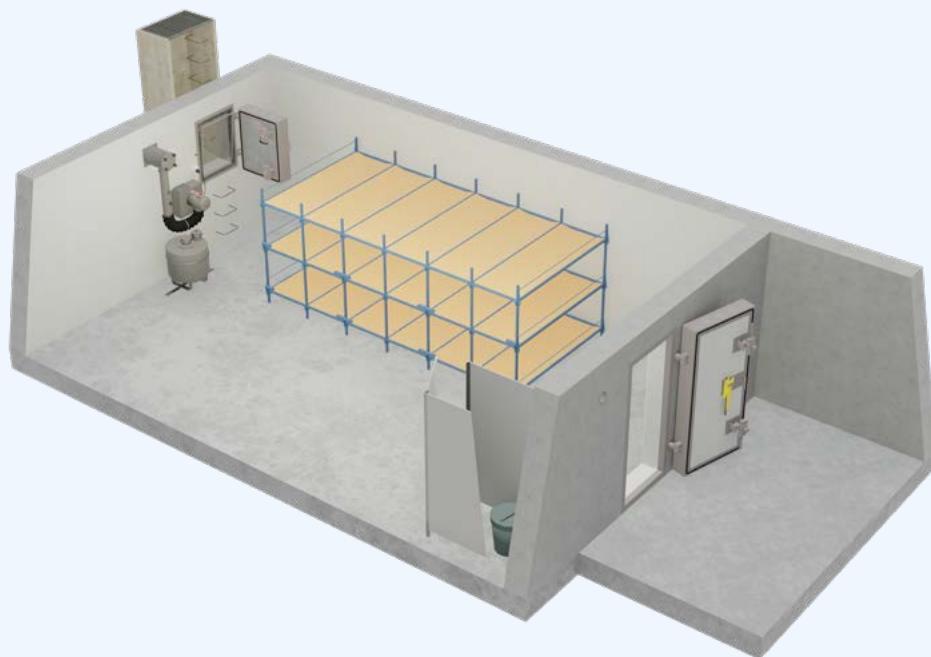
Fig. 9 I letti e le latrine a secco fanno parte dell'equipaggiamento obbligatorio. In caso d'occupazione dei rifugi, devono essere portati nel rifugio e montati secondo le istruzioni.
